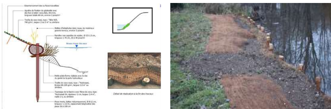
Figure 10 : Schéma de principe de la création d'une zone de frayère à brochet selon le principe de fascinage d'hélophytes (source : www.enseeiht.fr ).
